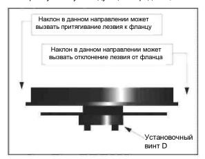
Проверка регулировки лезвия
